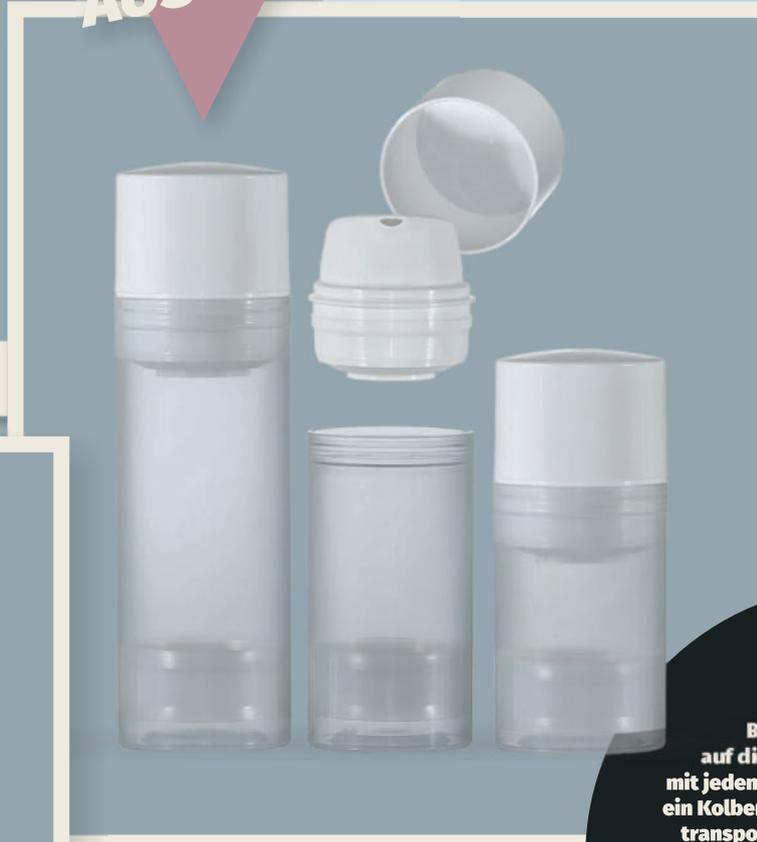
**Bei den Airless-System auf dieser Doppelseite hebt sich mit jedem Druck auf die Spenderpumpe ein Kolben im Inneren des Behälters und transportiert das Füllgut zur Pumpe. Dadurch wird keine neue Luft hinein geführt. Die Flasche wird in zwei Einzelteilen geliefert (Kopfstück und Behälter). Nach dem Befüllen wird das Kopfstück mit ein wenig Druck auf den Behälter geprellt und somit verschlossen.**
